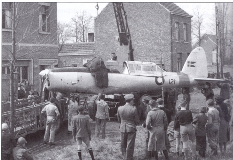
▲ Efter nødlandingen på en mark den 15. april 1950 var det nødvendigt at adskille Chipmunk nr. 12/121 og med hjælp fra det belgiske flyvevåben bringe det til Antwerpen lufthavn, hvor der blev udført en nødtørftig reparation, inden SIN nogle dage senere sørgede for at bringe det tilbage til fabrikken i England. Foto: L.B. Andersen.
