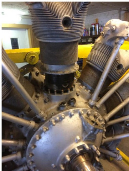
Første cylinder løftets fri, Bemærk det brune feronat
