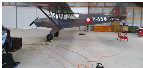
AZZ på vægtene i hangaren i Ringsted. En del lettere end hidtil. Ny tomvægt er 395 kg.
